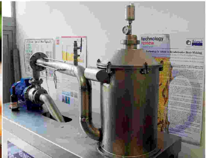
La birra perfetta? Secondo gli scienziati del Cnr si può realizzare con un processo di «cavitazione idrodinamica». Sopra, l'apparato di birrificazione realizzato dai due team, che hanno già prodotto migliaia di bottiglie
