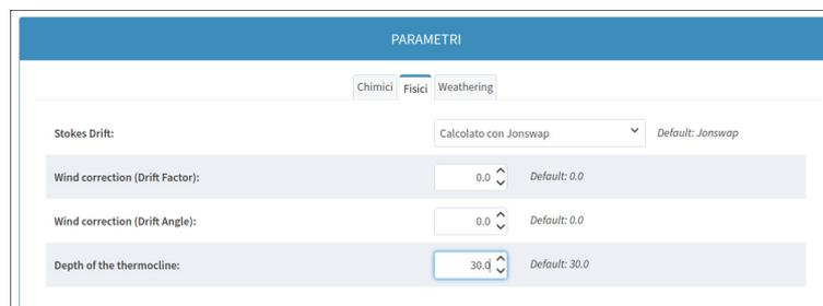
**Fig. 6:** Schermata della scheda Dati di Input, Parametri Fisici per la definizione del contributo alla dispersione della macchia dato dalle onde e dal vento. Sono visibili le impostazioni di default.
