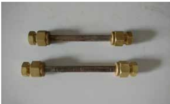
Figura 2. Tubi adsorbenti per l'analisi dei VOC (A) e Gas Cromatografo-Spettrometro di Massa (B) - Foto Ibe CNR-Bologna
