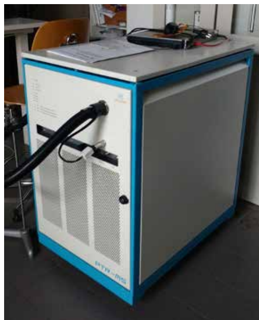
Figura 3. Spettrometro di massa con reazione a trasferimento di protoni (PTR-MS)- Foto Ibe CNR Bologna
