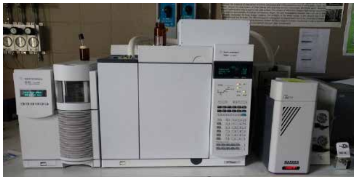
Figura 2. Tubi adsorbenti per l'analisi dei VOC (A) e Gas Cromatografo-Spettrometro di Massa (B) - Foto Ibe CNR-Bologna
