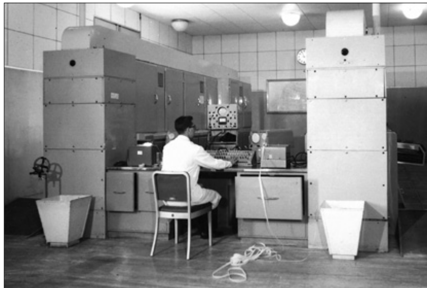
Fig. 12 La FINAC al lavoro; a destra e a sinistra dell'operatore si riconoscono i due lettori veloci di nastro perforato; guardando bene si nota che il groviglio di nastro continua nell'apposito raccogliitore bianco, 1956 (foto CNR).
