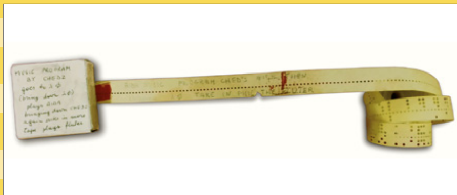
Fig. 9 Nastro perforato con il programma per far suonare al Ferranti la Marcia Trionfale dell'Aida, usato all'inaugurazione il 14 dicembre 1955 (collezione privata Gianfranco Camarda).
