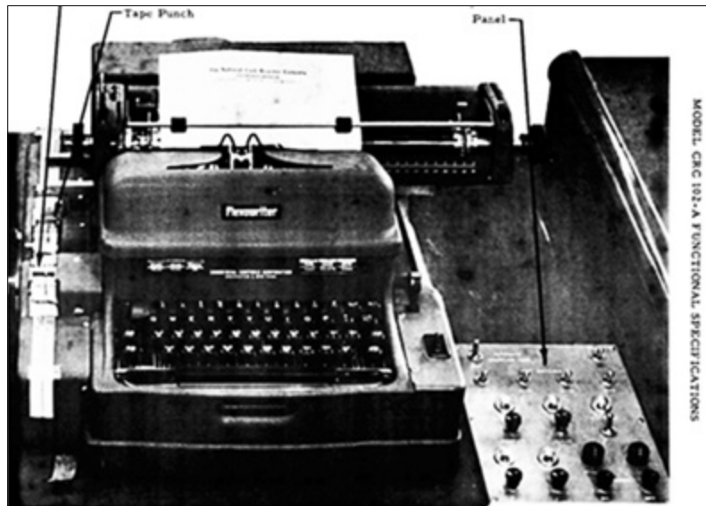
Fig. 7 La consolle della macchina. Sulla sinistra la telescrivente Flexodwriter con nastro perforato per ingresso e uscita da dieci caratteri al secondo; sulla destra il pannello di controllo (Foto di proprietà del Politecnico di Milano, 1954 circa).
