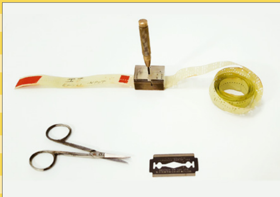
Fig. 10 Attrezzatura per correggere a mano i nastri perforati a 5 fori (collezione CNR-IAC).
