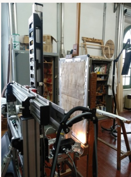
A sinistra: Mappatura XRF del rotolo ebraico della Biblioteca Nazionale Centrale di Firenze presso il CNR INO di Firenze. © Alessandro Sidoti
