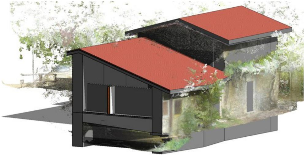
**Figura 1.** Modellazione parametrica del mulino attraverso la procedura Scan-to-BIM: spaccato assonometrico.
