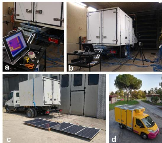
**Figura 1.** Sviluppo di un prototipo di veicolo commerciale leggero per trasporto refrigerato supportato da pannelli fotovoltaici: caratterizzazione della cassa isolante (a, b); test di autonomia (c); prototipo ingegnerizzato (d).
