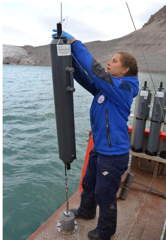
Campionamento di acque superficiali con bottiglie Niskin a bordo della MS-Teisten. Credit: M. Sabino - ISP
