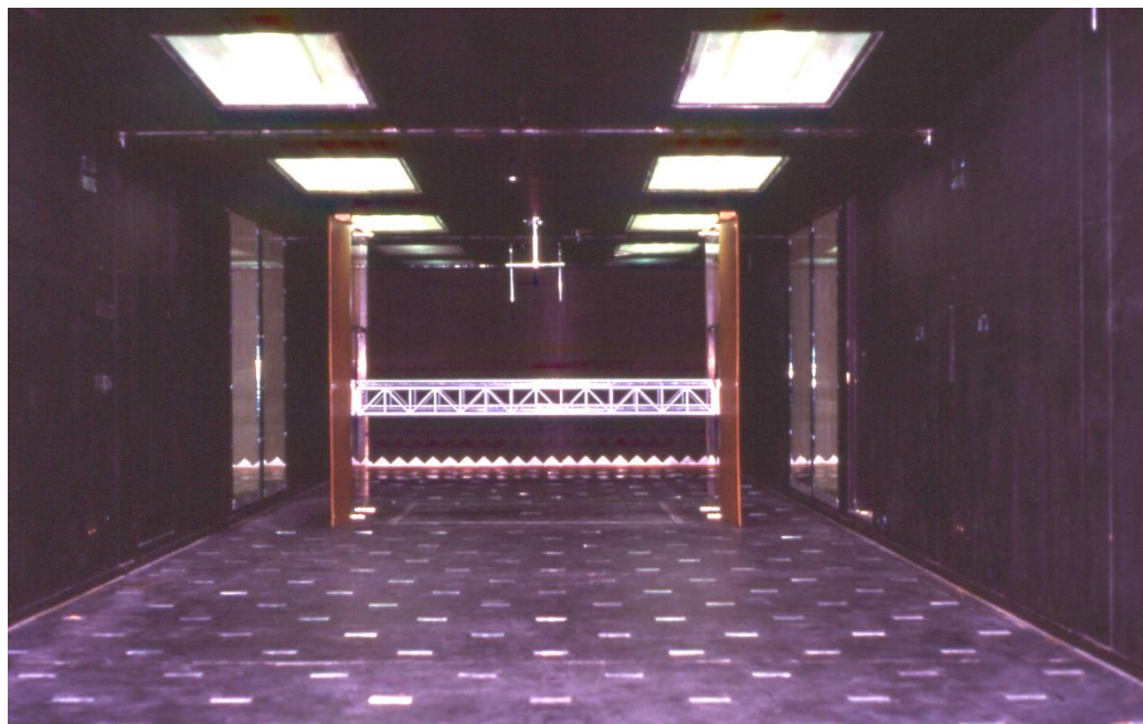
Figura S.6 – Prova su modello sezione di un impalcato da ponte.
