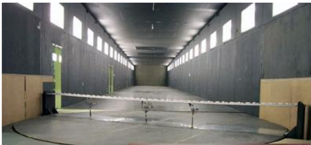
Figura S.10 – Prova su modello a nastro teso di un ponte sospeso.
