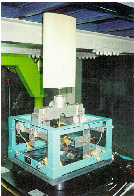
Figura S.9 – Prova su modello a pivot di un edificio.
