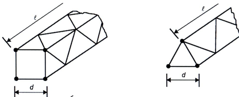
Figura G.43 – Dimensioni caratteristiche dei tralicci.
