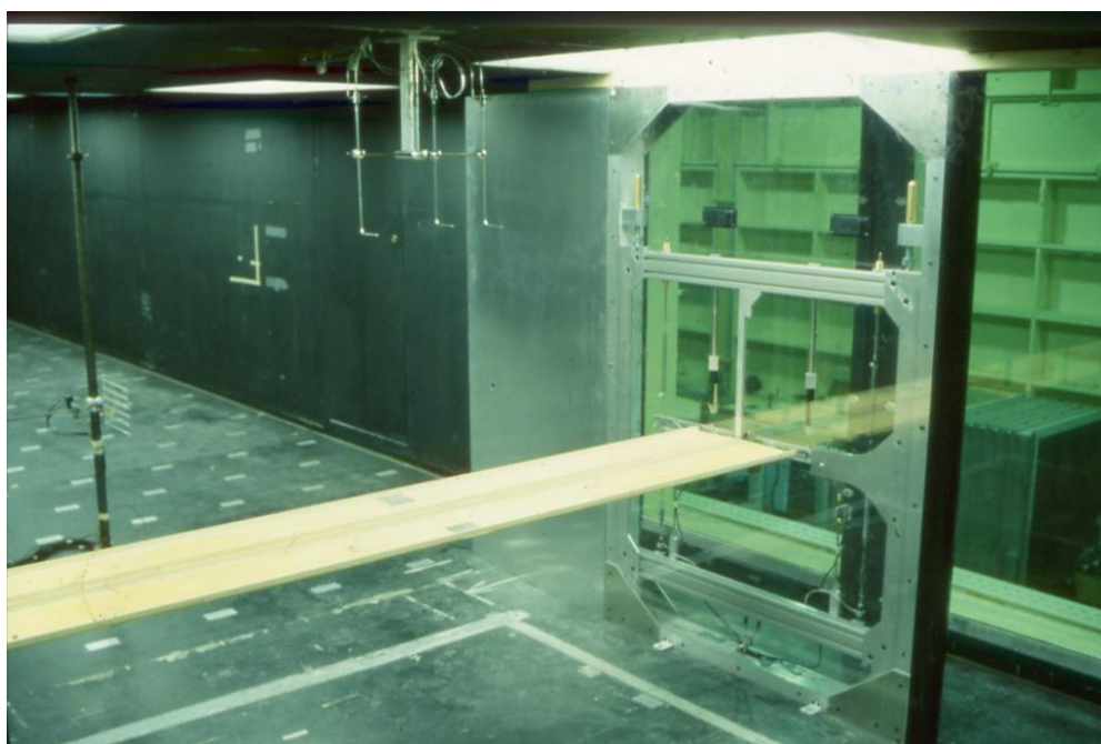
Figura S.8 – Prova su modello sezione di impalcato da ponte.
