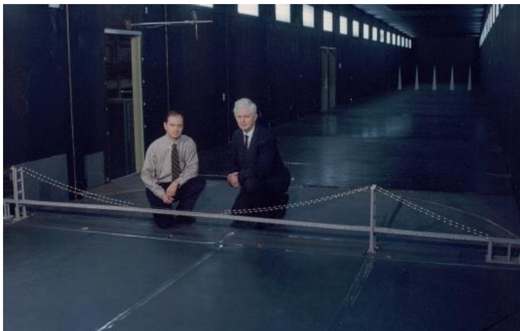
Figura S.7 – Prova su replica aeroelastica di ponte sospeso.
