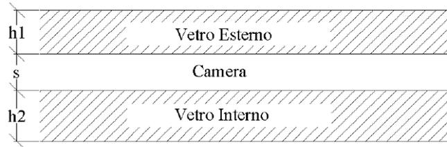
Figura 6.19. Sezione di un elemento di vetro-camera.
