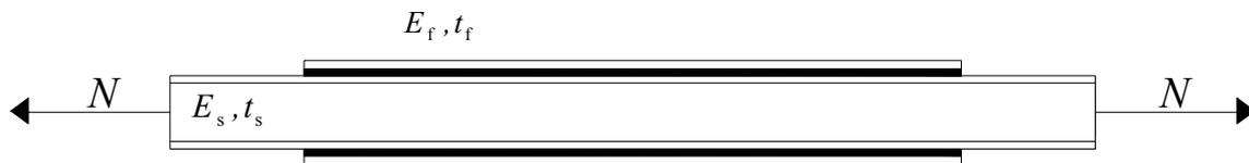
**Figura 4-2** – Elemento teso integro con rinforzo simmetrico.
