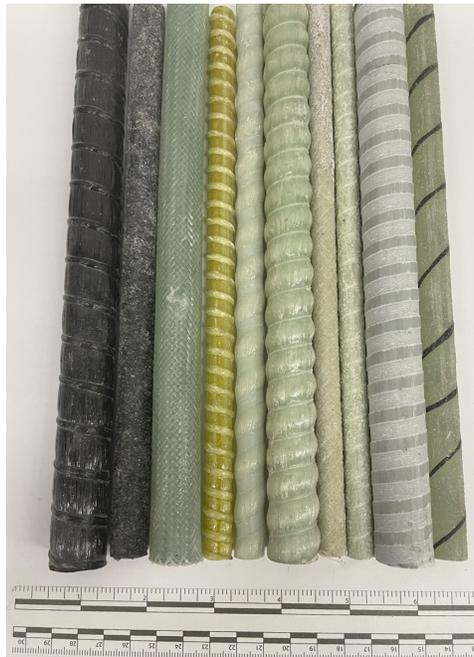
Figura 15-1. Esempi di diverse tipologie di barre di FRP presenti sul mercato.
