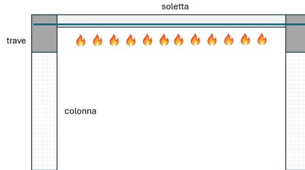
Figura 16-4 – Soletta esposta all'azione del fuoco – ancoraggio dell'armatura nella trave in calcestruzzo
