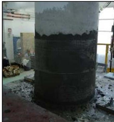
Figura 2.14 – Confinamiento de columna con tejido metalico galvanizado unidireccional y mortero.
