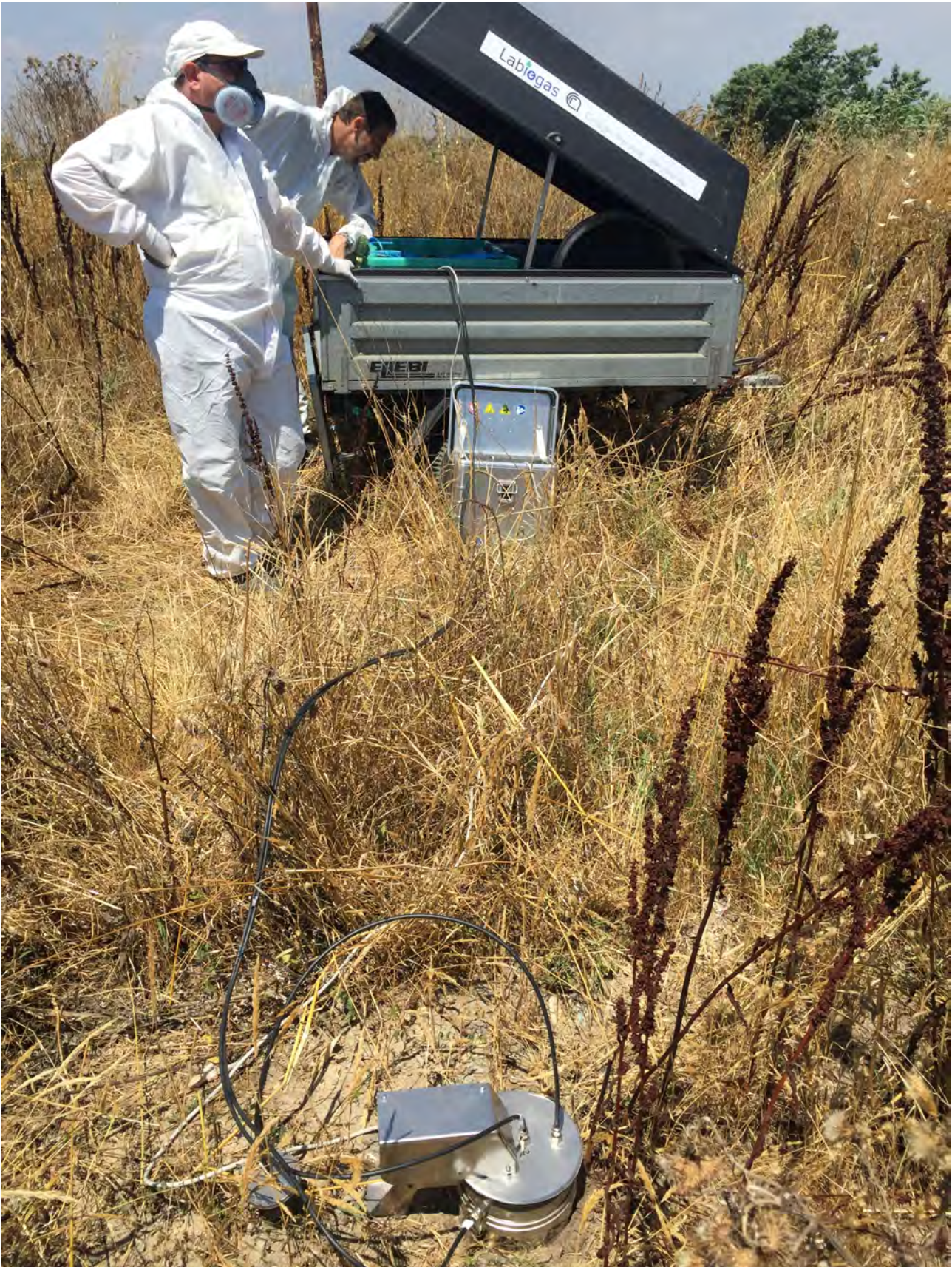
Figura 2 - le misure di emissione dal substrato utilizzano il laboratorio mobile LabGas e sistemi di camere automatiche
