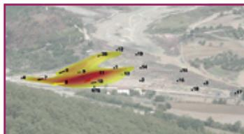
© 3DA, Three-dimensional Displacement Analysis è un sistema software per la produzione di mappe tridimensionali di deformazione a partire da misure topografiche puntuali effettuate utilizzando stazioni totali.
