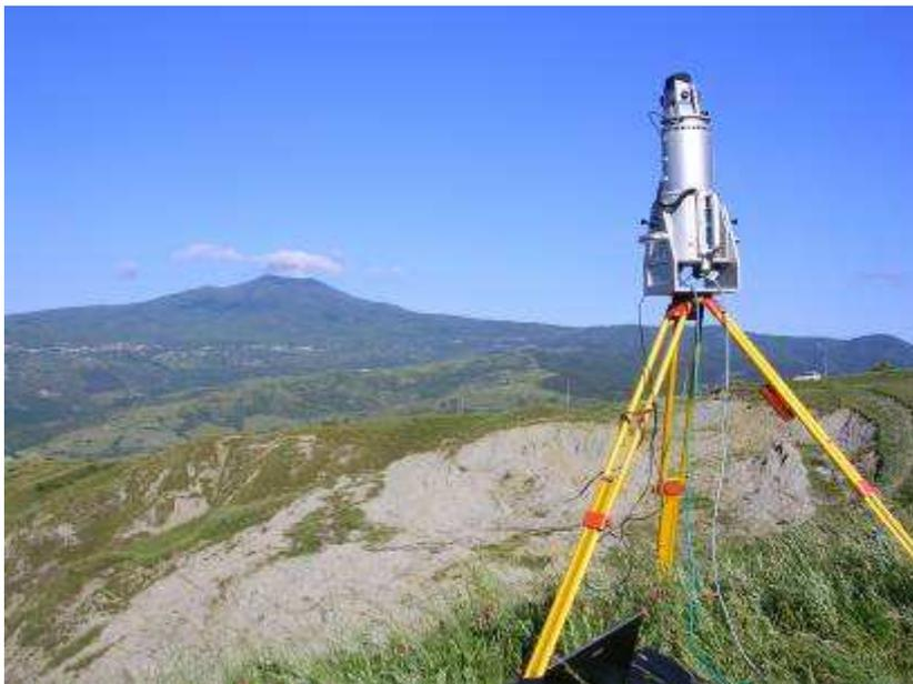
Fig. 1 laser scanner terrestre e vista del fenomeno franoso. Sullo sfondo si vede il M. Amiata.
