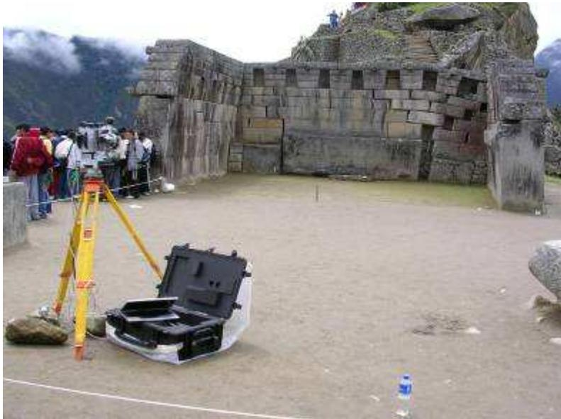
Fig. 4 rilievo con laser scanner terrestre del Tempio Principale della Cittadella Inca di Machu Picchu Perù eseguito dal CNR IRPI di Torino nell'ambito del Progetto INTERFRASI.
