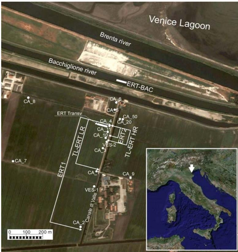
Fig. 1 - Mappa dell'esperimento e ubicazione geografica. Il sito sperimentale dista circa 600 m dal limite della laguna. L'esperimento elettro-tomografico tempo variante è costituito da 2 linee, la prima a bassa risoluzione (TL-ERTLR) è lunga circa 300 m e la seconda ad alta risoluzione (TL-ERTHR) campiona i primi 100 m della precedente nel settore prossimo alla laguna.
