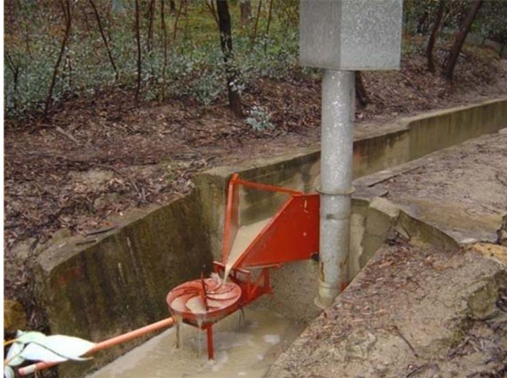
**Fig. 3** – Edificio di misura dei deflussi e campionatore di torbide
