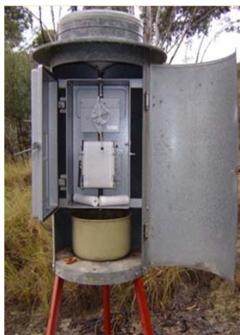
**Fig. 2** – Pluviografo a bascula per la misura delle precipitazioni
