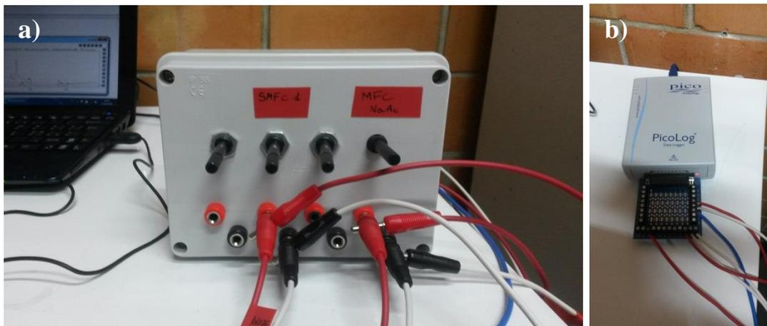
**Figura 2.** Scatola per il controllo della resistenza applicata su 4 canali indipendenti (a); sistema di misurazione e acquisizione dati (b).
