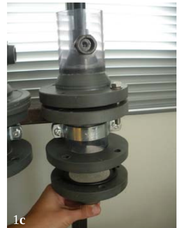
Figura 1: a) visione d'insieme dell'apparato sperimentale per la prova di permeabilità; b) e c) dettaglio sui portacampioni.
