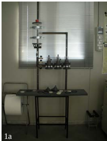
Figura 1: a) visione d'insieme dell'apparato sperimentale per la prova di permeabilità; b) e c) dettaglio sui portacampioni.
