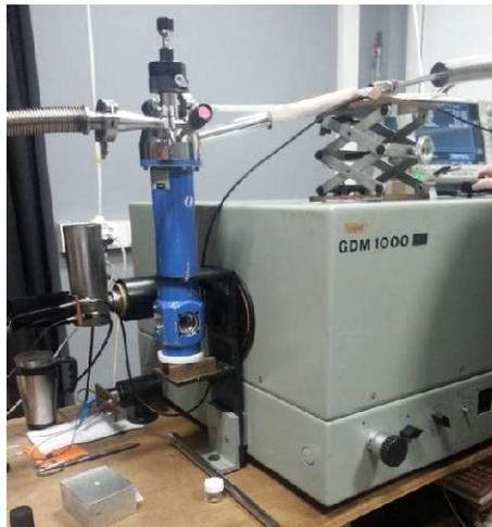
*Figura 1 – Dettaglio dell'apparato sperimentale utilizzato per le misure di emissione. Sono visibili il doppio monocromatore GDM1000, il criostato (il cilindro blu verticale) con le connessioni di ingresso e uscita dell'He, e l'oscilloscopio digitale Tektronix (sulla destra).*
