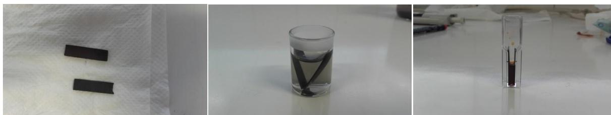
**Figura 1** - Da sinistra verso destra: sezioni di grafite scelte per l'esperimento, rivestimento delle sezioni di grafite con polidopamina, immobilizzazione dell'enzima sugli elettrodi rivestiti.
