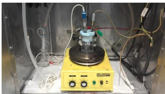
**Figura 3** – Cella elettrochimica per cronoamperometria sul biosensore.
