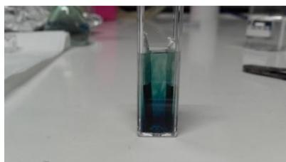
**Figura 2** - Biosensori durante l'immersione in cuvetta contenente la soluzione per il saggio enzimatico spettrofotometrico.
