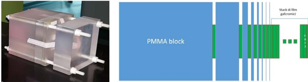
Figura 4 – Configurazione di irraggiamento dei film radiocromici.
