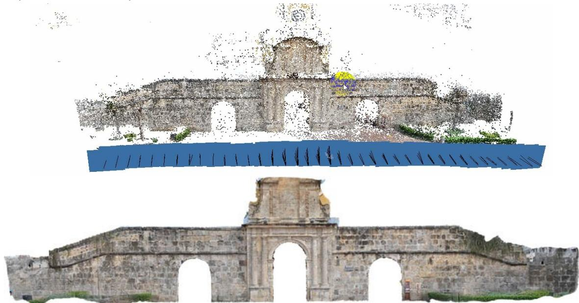
Fig. 4: Prime elaborazioni con il software di fotogrammetria digitale. Nuvola di punti e fotopiano dell'area della *Torre del Reloj*
