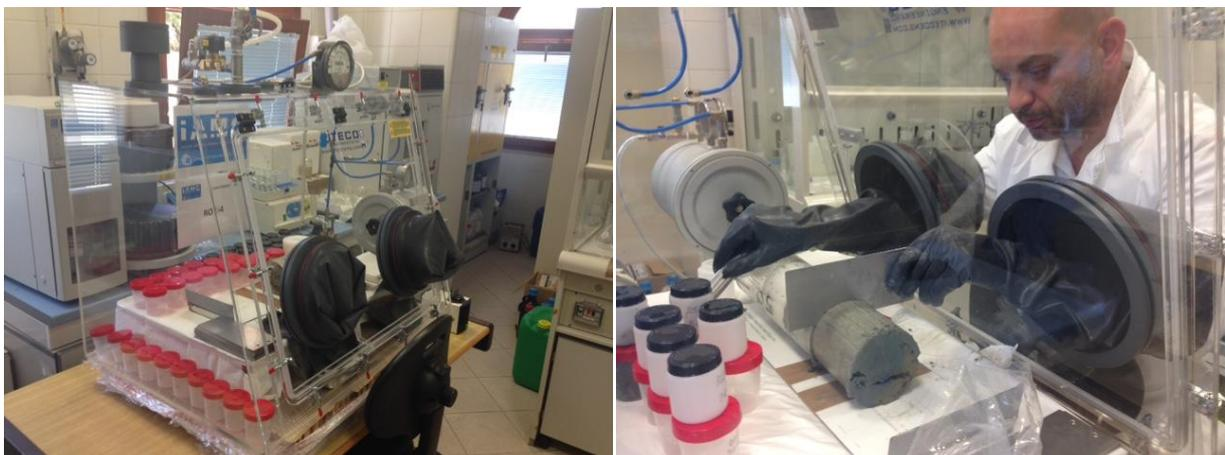
**FIGURA 3:** ESTRUSIONE E SUB-CAMPIONAMENTO DELLE CAROTE ALL'INTERNO DELLA GLOVE-BOX.
