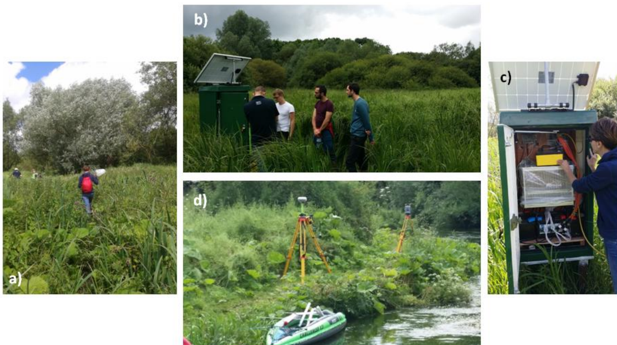
Figura 3 - Sistema Prime installato nelle wetlands nei pressi della città di Boxford nel Berkshire (UK). a) wetlands; b) sistema PRIME; c) zoom sul sistema di acquisizione; d) strumentazione elettromagnetica e topografica
