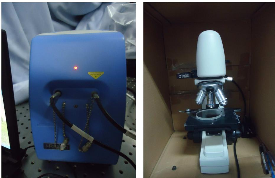
**Fig. 10:** Sistema Raman BWS415-B&W TekInc utilizzato per le valutazioni dell'EF SERS.
