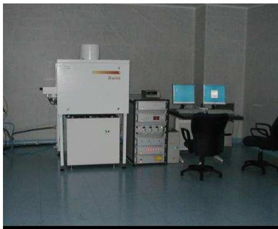
**Fig. 2:** Sistema EBL RAITH 150 utilizzato per la fabbricazione delle nanostrutture.
