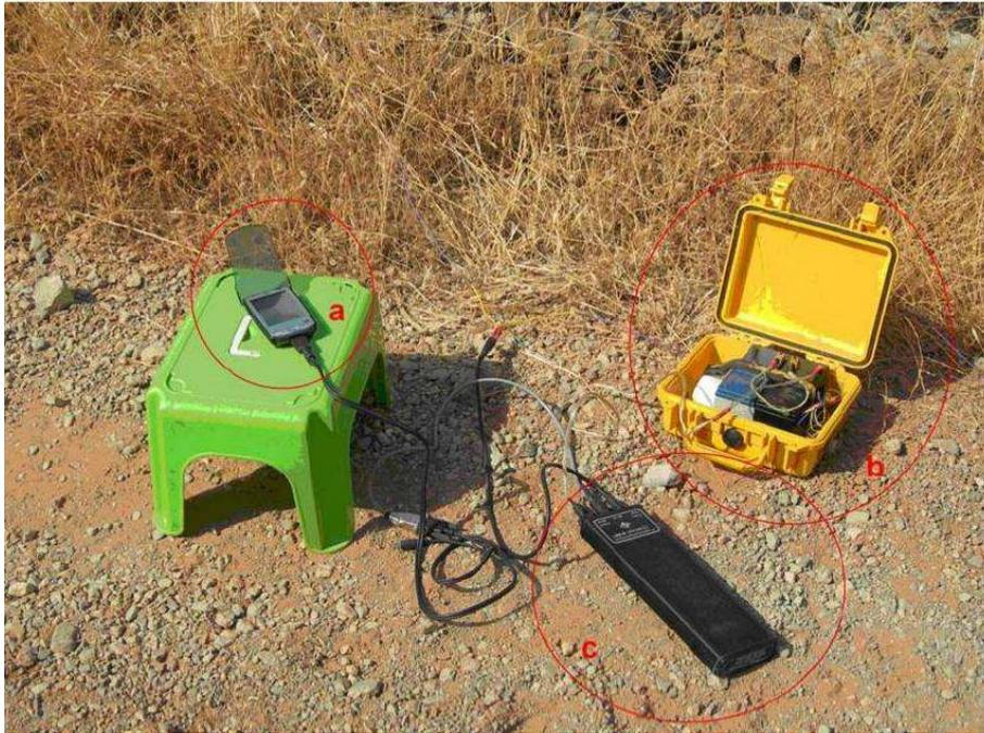
**Figura 3 - Strumentazione TEM: a) palmtop PC; b) batteria esterna (12V+12V in serie=24V); c) TEM Fast 48 sysetm.**
