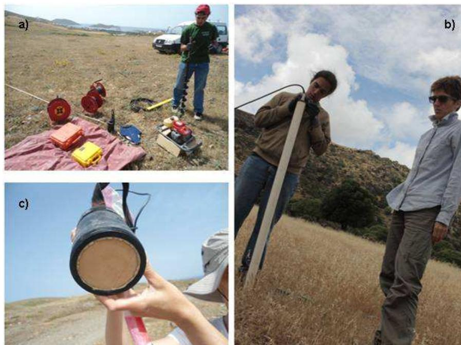
**Figura 2 - Strumentazione MT: a) MT-24/LF (24-bit A/D Low-frequency systems); b) sensore magnetico; c) sensore elettrico.**
