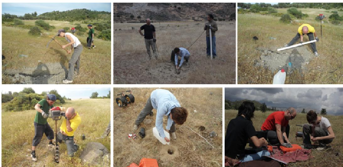
**Figura 5 - Operazioni necessarie per l'installazione dei sensori MT.**
