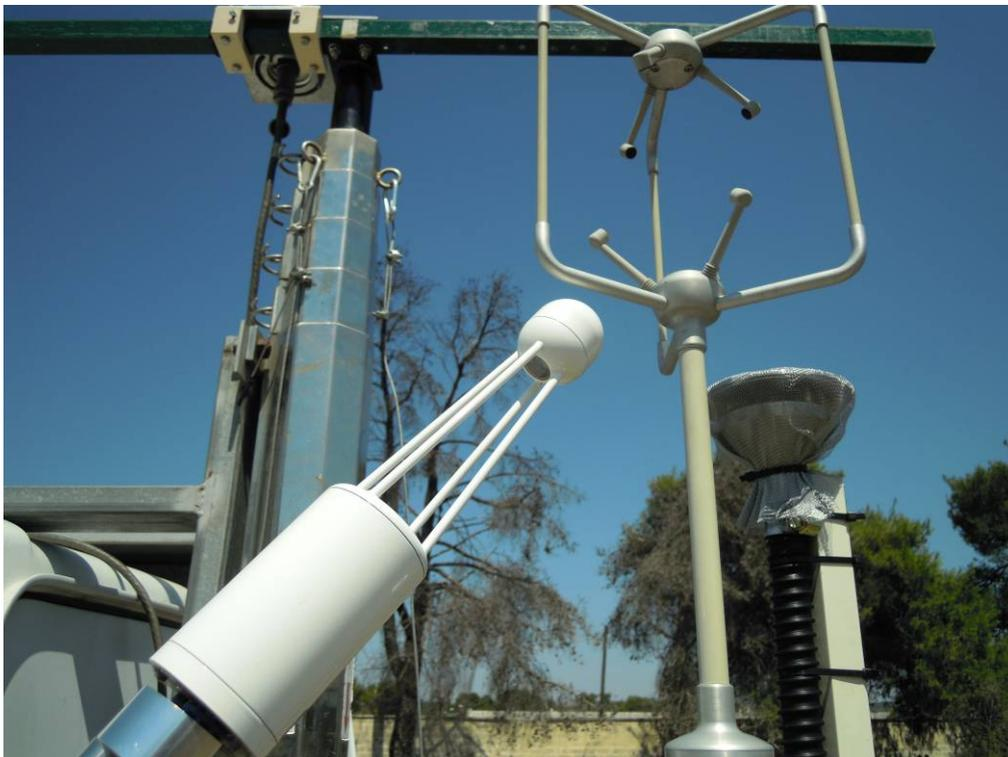
Fig.5. Posizionamento del Licor Li7500 rispetto all'anemometro sonico in posizione inclinata per evitare la deposizione di acqua piovana.
