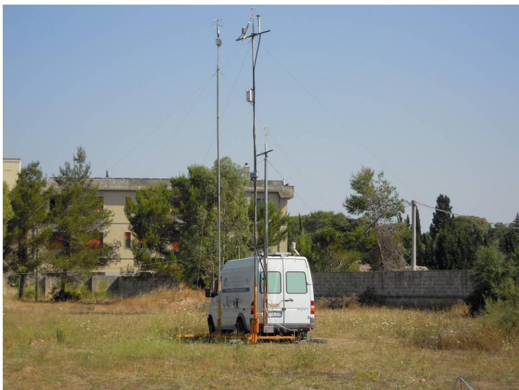
Fig.2. Laboratorio mobile con le due postazioni a 10 m (A,B) e la postazione a 6 m (C).
