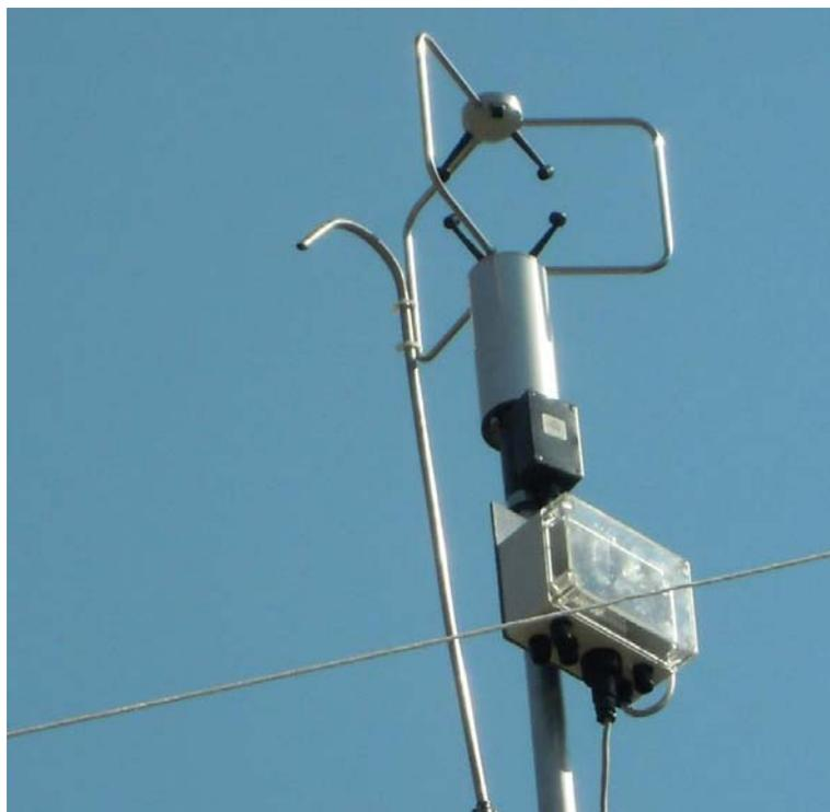
Fig.6. Postazione B (10m). Si può vedere la testa di campionamento per ELPI e l'anemometro sonico.
