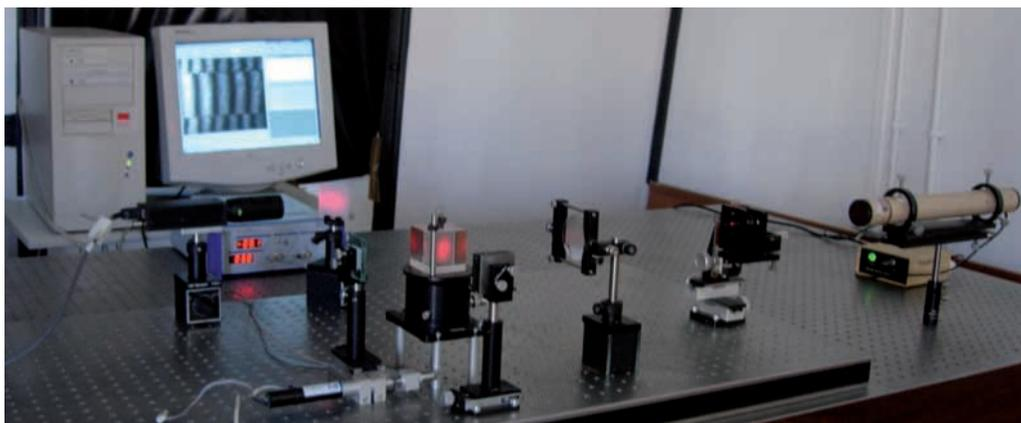
Figura 15: *Interferometro a variazione di fase*
