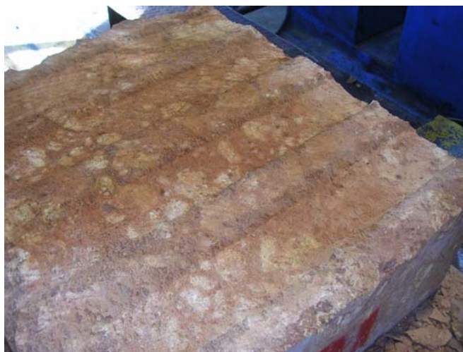
Figura 6 - Tracce delle prove di scavo
