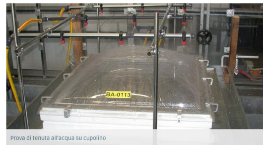
Prova di tenuta all'acqua su cupolino
