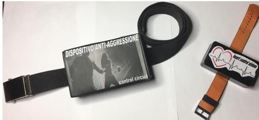
Il progetto realizzato consiste in un prototipo anti-aggressione “portatile” in grado di rilevare e segnalare tramite un messaggio l’eventuale aggressione o malessere del portatore mediante un ricetrasmittitore che invia le coordinate gps. Il dispositivo è dotato di sensori per il rilevamento di alcuni parametri clinici (battito cardiaco, accelerazione ecc.) e invia le informazioni raccolte e la posizione del portatore a predefiniti contatti salvati nella rubrica telefonica.
